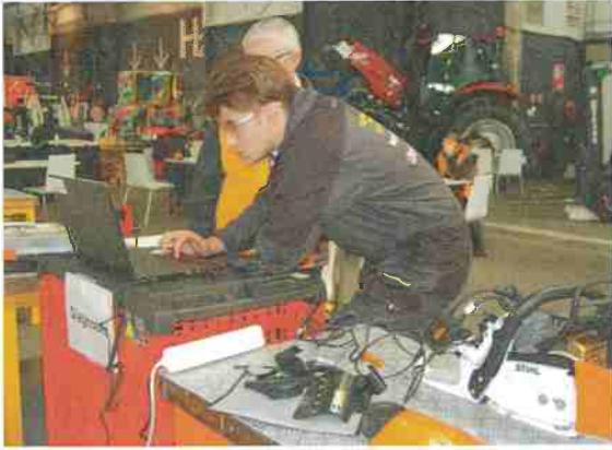
Diagnostic de panne grâce à la valise reliée à la tronçonneuse Stihl.
